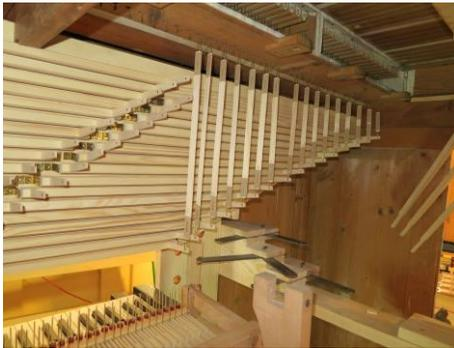
Um eine exakte Rekonstruktion der Mechanik zu erreichen, beauftragte Rainer Wolter die Kunstschlosserei Andreas Lau in Halle, Metallwellenhalter, die Winkel und Verbindungsstifte der Registerzüge nach historischem Muster anzufertigen.
